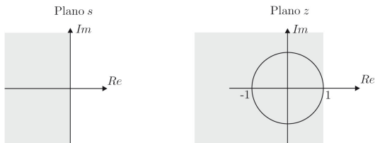
Figura 12.2 Mapeamento do plano s no plano z com a aproximação retangular para a frente.
