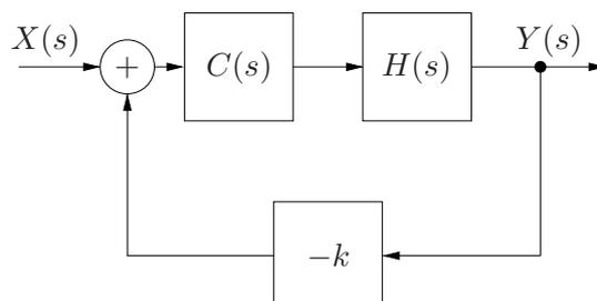
com  $H(s)$  representando a função de transferência do sistema original (computada no item (c)) e  $C(s) = \frac{s-2}{s^2+2s+2} = \frac{s-2}{(s+1-j)(s+1+j)}$  (0,2 ponto).
